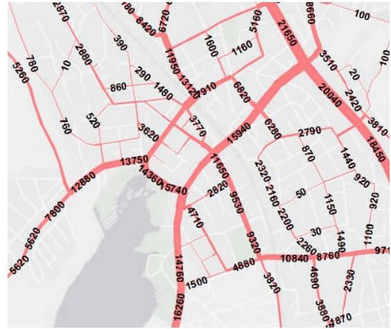
Myllytien liikennemäärät, vasemmalla nykytilanne ja oikealla ennustetilanne v.2040 (KAVL) (Järvenpään liikennejärjestelmäsuunnitelman liikennemallinnus, ennakkotieto 09/2019, Sitowise)
