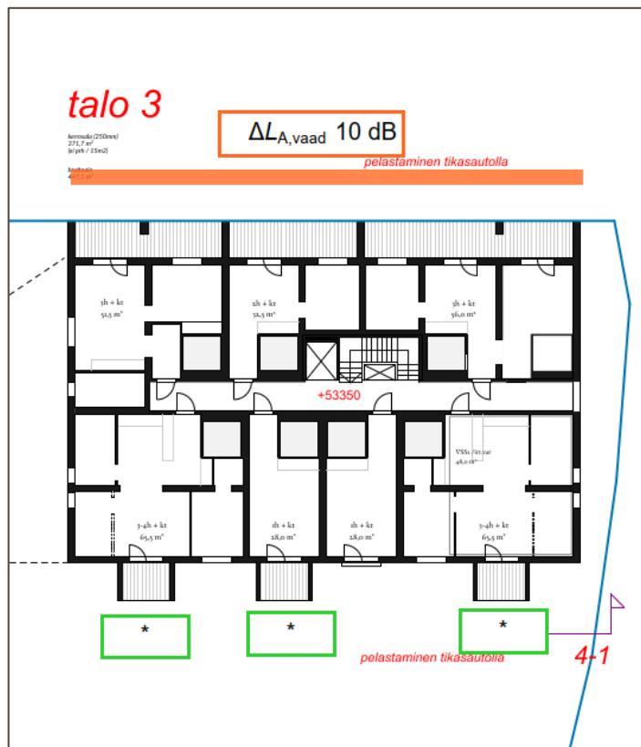
Kuva 5. Talo 3: Lasitettujen parvekkeiden äänitasoerovaatimukset \Delta L_{A,vaad} . Vihreällä laatikolla (*) merkityillä parvekkeilla ohjearvotaso täyttyvät tavanomaisella lasituksella, eikä parvekkeiden meluntorjuntaa tarvitse mitoittaa erikseen.
